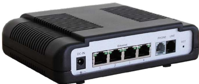
qBRIDGE-308 представляет собой высокопроизводительный конвертер/ мост, предназначенный для соединения удаленных сегментов LAN посредством технологии VDSL2 по одной медной телефонной линии. Устройство позволяет получить соединение на скорости входящего потока до 100 Mbps, исходящего – до 85 Mbps при асимметричной передаче данных и длине линии до 300 м. Максимальная длина линии при диаметре жилы 0.5 мм составляет 1700 м.
