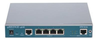
**qBRIDGE-406** представляет серию высокопроизводительных SHDSL.bis модемов, построенных в соответствии со стандартом IEEE 802.3ah "Ethernet in the First Mile" (EFM). Линейный интерфейс модема позволяет объединять до четырех медных пар различного качества для организации симметричного канала 2BASE-TL, используя модуляцию TCPAM-16/32/128. При этом обеспечивается линейная скорость до 61.2 Mbps (до 15,3 Mbps по каждой паре).
