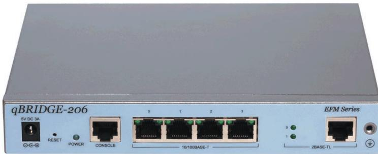
**qBRIDGE-206N** открывает собой новую серию высокопроизводительных SHDSL.bis модемов, разработанных в соответствие со стандартом IEEE 802.3ah "Ethernet in the First Mile" (EFM). Линейный интерфейс модема позволяет объединять до двух медных пар различного качества для организации симметричного канала 2BASE-TL, используя модуляцию TSPAM-32. При этом обеспечивается линейная скорость до 11.4 Mbps (до 5,7 Mbps по каждой паре).
