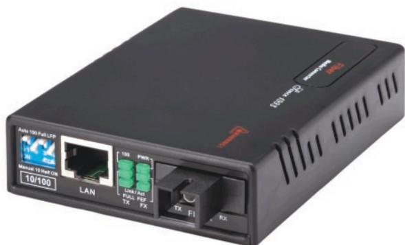
Предназначены для преобразования сигналов между медными 10/100Base-TX и оптическими 100Base-FX сегментами сети Fast Ethernet. На лицевой панели расположены: оптический разъем типа SC, разъем Ethernet RJ-45, DIP-переключатели, светодиодные индикаторы, которые информируют о наличии питания, скорости передачи и статусе сетевого и оптического интерфейсов.
