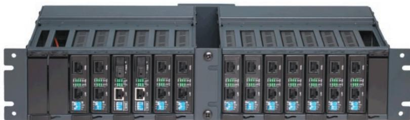
Конвертеры можно использовать как отдельно стоящее устройство так и устанавливать в 19" шасси R208 на 8 / 16 медиаконвертеров с питанием 220 VAC или 48 VDC. Для питания отдельного медиаконвертера используется внешний адаптер 12V/1A. Данное напряжение часто используется для питания видеокамер наблюдения. Поэтому медиаконвертер по основным параметрам пригоден для подключения удаленных IP-телекамер и любого другого оборудования с Ethernet интерфейсом.
