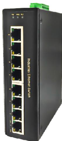
Промышленный коммутатор NIS-3200-008G имеет 8 гигабитных медных Ethernet порта 10/100/1000Base-T. Коммутатор отлично подходит для построения узлов сети IP-видеонаблюдения. Устройство обеспечивает неблокирующую многоходовую коммутацию и передачу данных с пропускной способностью 16 Гбит/с.
