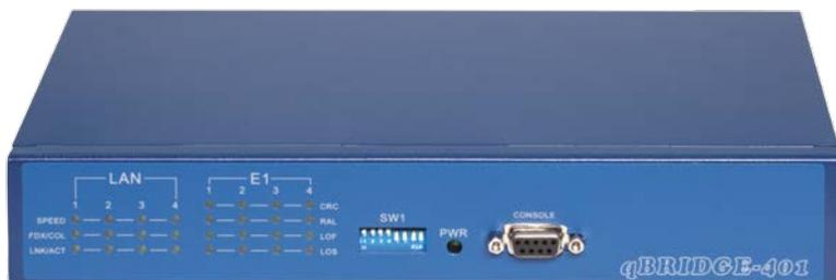
Инверсный мультиплексор qBRIDGE-401 предназначен для соединения удаленных сегментов LAN через транспортные сети PDH/SDH с возможностью объединения 4 каналов E1 для передачи Ethernet трафика. Максимальная скорость составляет 7.68 Mbps при использовании всех четырех каналов E1.
