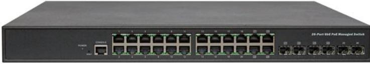
**DAS-6G20GP** управляемый L2+ коммутатор для построения надежной инфраструктуры в операторских приложениях и для построения узлов сети IP-видеонаблюдения/ IP-Surveillance.
