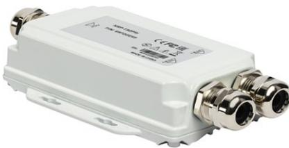
Устройства просты в инсталляции и работают в режиме "Plug & Play". Входной порт подключается к оборудованию PSE (PoE инжектор или PoE коммутатор) а выходные порты к оборудованию PD (IP-видеокамера или беспроводная точка доступа) или к следующему удлинителю при каскадном соединении.
