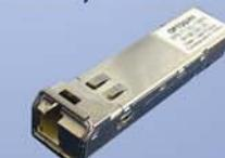
Оптические трансиверы в стандартных SFP металлических корпусах с объединенным оптическим входом / выходом под разъем типа LC для передачи сигнала по одному оптическому волокну. Предназначены для применения в оптических мультиплексорах, SDH-оборудовании, устройствах типа Fast Ethernet / Gigabit Switch.
