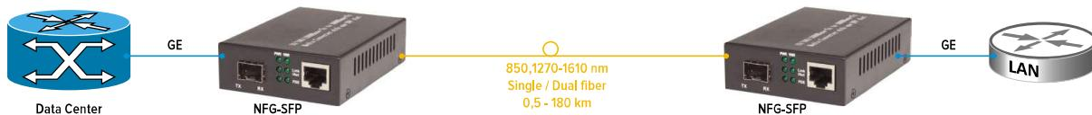
**Использование NFG-SFP в качестве транспондера-преобразователя медного 1000Base-T Ethernet в оптические линки с длиной волны CWDM**
