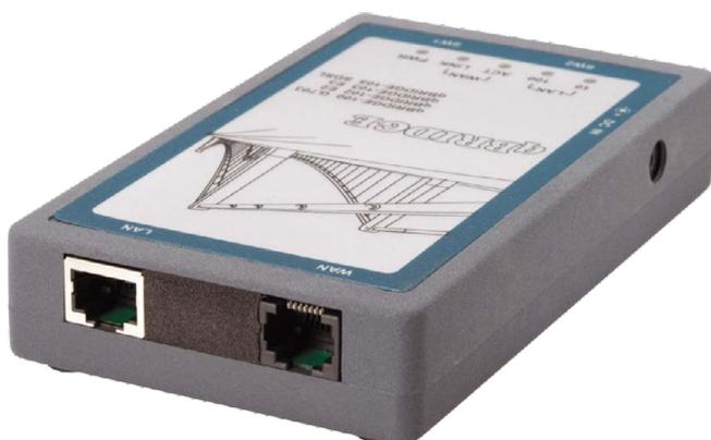
qBRIDGE-100 представляет собой конвертер/ мост, предназначенный для соединения удаленных сегментов LAN через стандартные каналы E1, работающие в режиме передачи неструктурированного потока данных с фиксированной скоростью 2.048 Mbps (E1 Unframed), с интерфейсом G.703.
