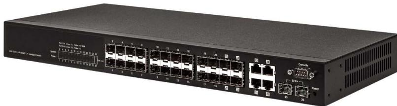
DAS-26G управляемый коммутатор доступа/ агрегации для различных приложений: FTTH, FTTB, в том числе сети IP-видеонаблюдения. Имеет 20 SFP слотов для подключения устройств по оптическому волокну, 4 комбо-порта TP/SFP и 2 порта SFP+ для подключения к магистрали. Оптические порты SFP поддерживают скорость передачи 100M и 1Gb, SFP+ до 10Gb.
