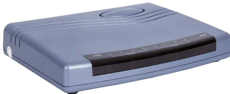
qBRIDGE-406R представляет собой SHDSL.bis модем/ маршрутизатор, разработанный в соответствии с новым стандартом IEEE 802.3ah «Ethernet in the First Mile» (EFM). Линейный интерфейс устройства позволяет объединять до четырех медных пар различного качества для организации симметричного канала 2BASE-TL, используя модуляцию TSPAM-16/32/64/128. При этом обеспечивается линейная скорость до 61.2 Mbps (до 15,3 Mbps по каждой медной паре).
