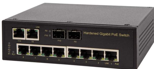
PoE коммутатор NIS-3200-208PSG имеет 8 портов Ethernet 10/100/1000Base-T и два совмещенных гигабитных TP/SFP порта для подключения к магистрали. Магистральные порты могут работать как обычные «медные» со скоростью 10/100/1000М через разъем RJ45 или как оптические порты со скоростью 1000М.
