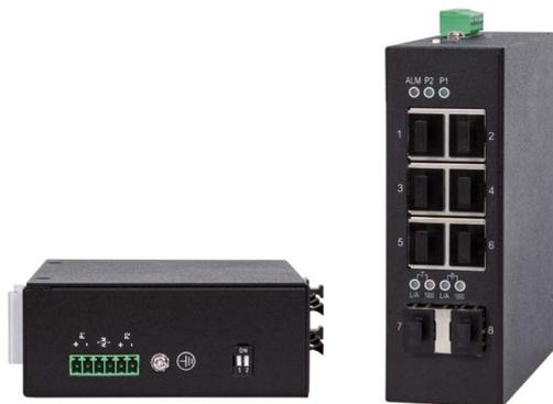
Промышленный коммутатор NIS-3200-206GS имеет 6 портов Ethernet 10/100/1000Base-T и два слота для установки SFP модулей и отлично подходит для построения узлов сетей IP-видеонаблюдения. Устройство обеспечивает коммутацию и передачу значительных массивов данных с пропускной способностью до 16 Gbps.
