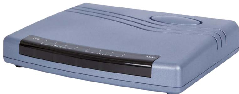
qBRIDGE-106R представляет собой SHDSL.bis модем с поддержкой режима работы «Мост». Предназначен для решения проблем «последней мили», соединения удаленных сегментов LAN, подключения пользователей к Internet. Устройства обеспечивают симметричную полнодуплексную передачу данных по одной медной витой паре в диапазоне скоростей от 200 Kbps до 15,3 Mbps.
