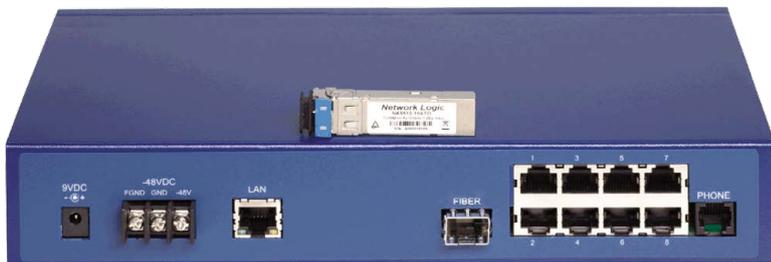
FoMUX - серия мультиплексоров, предназначенных для прозрачной передачи цифровых каналов с различными интерфейсами по оптоволоконному кабелю. Мультиплексоры FoMUX-4LE обеспечивают простое и экономичное решение для одновременной передачи 4 или 8 каналов E1, Ethernet 10/ 100 Mbps и асинхронного канала с интерфейсом RS-232C.
