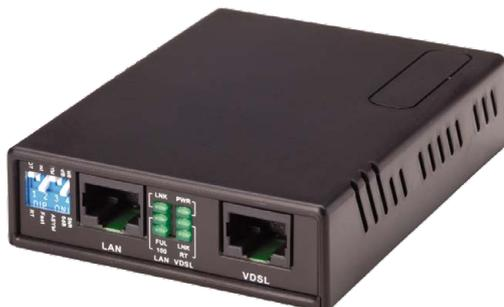
qBRIDGE-307m - простые и надежные однопортовые VDSL2 конвертеры, которые позволяют получить соединение на скорости входящего потока до 100, а исходящего - до 75 Mbps при асимметричной передаче данных и длине линии до 300 м. Кроме этого, поддерживается режим симметричной передачи. В простейшем случае, для соединений по схеме «точка-точка», с помощью лишь одного переключателя достаточно установить на одном устройстве режим ведомого, а на другом - ведущего.
