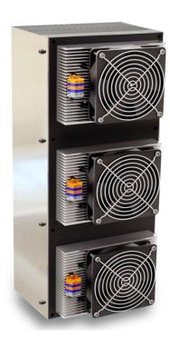
Термоэлектрическая система охлаждения (TCO) предназначена для отвода избыточного тепла от электронного оборудования, установленного внутри закрытого монтажного шкафа со степенью защиты IP66. TCO представляет собой термоэлектрический кондиционер, работающий на основе эффекта Peltier. Основные преимущества TCO по сравнению с обычным компрессором:
