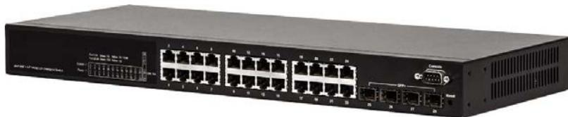
DAS-28T управляемый коммутатор доступа/агрегации для различных приложений: FTTH, FTTB, в том числе сети IP-видеонаблюдения (IP-Surveillance). Коммутатор имеет 24 медных порта Ethernet 10/100/1000Base-T и 4 SFP+ слота (1/10GbE) для подключения к магистрали. Коммутатор поддерживает стекирование (до 16 шт).
