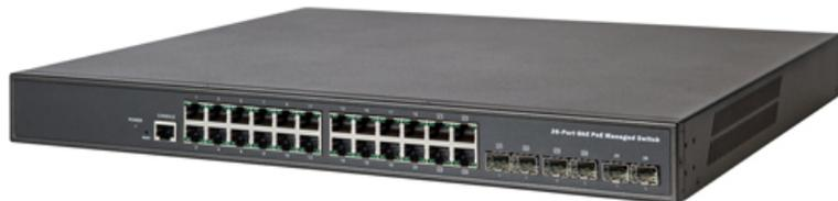
DAS-6G20GP управляемый L2+ коммутатор для построения надежной инфраструктуры в любых операторских приложениях, построения узлов сети IP-видеонаблюдения (IP-Surveillance), а также в промышленной автоматизации. Коммутатор имеет два 1G SFP слота и 24 медных (RJ-45) порта Ethernet 10/100/1000Base-T с поддержкой PoE, четыре из которых выполнены как комбо-порты TP/SFP (100M/1G).
