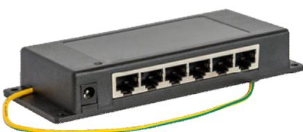
6-х портовый пассивный PoE-инжектор NIP-606PPG имеет только 6 пар RJ-45 разъемов. Устройство принимает на порты "Data" данные от коммутатора, а на порты "Power + Data" выдает те же данные и напряжение постоянного тока, которое подается на контакты разъема RJ-45 1/2(+), 3/6(-). С устройствами NIP-212PPG и NIP-606PPG могут быть использованы источники питания на 48-55VDC (120/150 или 240W) или 24VDC (120W). В этом случае мощность, выдаваемая на каждый порт составит от 10 до 20W.
