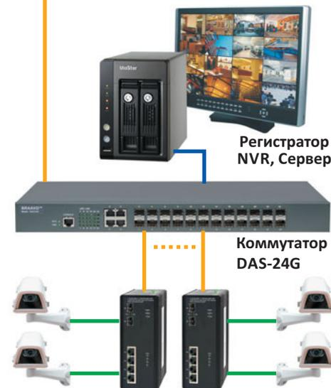
Схема подключения типа "Звезда"
