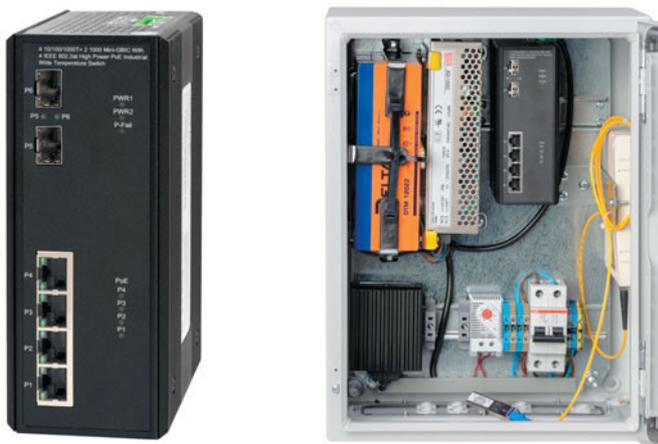
Полностью гигабитный PoE коммутатор NIS-3500-0204PSG имеет 4 порта Ethernet 10/100/1000Base-T и два слота для установки SFP модулей 1000M и отлично подходит для построения узлов сетей IP-видеонаблюдения с использованием IP-видеокамер самого высокого разрешения. Устройство обеспечивает неблокирующую коммутацию и передачу массивов данных с пропускной способностью 12 Гбит/с.
