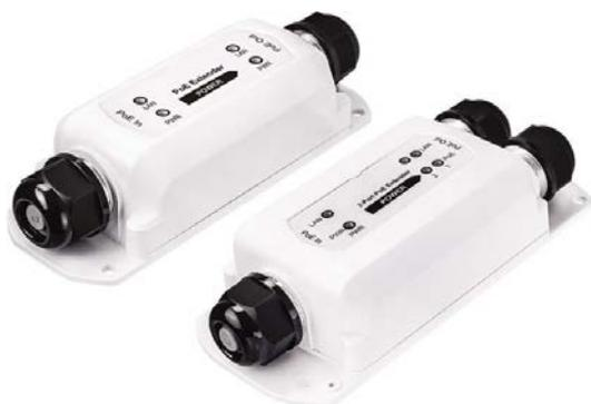
NRP-162PRi представляет собой всепогодный High-Power PoE Extender. Предназначен для увеличения длины сегментов сети Ethernet при передаче данных и питания PoE сверх обычных 100 м по кабелю UTP Cat5e или Cat6.
