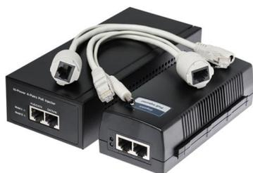
Технология Power over Ethernet (PoE) обеспечивает подачу напряжения питания через стандартную витую пару в сети Ethernet для удаленных устройств. Благодаря этому появляется возможность установки оборудования в наиболее подходящих для этого местах, например, точку доступа можно установить в месте наилучшего приема/передачи сигнала, а IP-видеокамеру в любом удобном для обзора месте.
