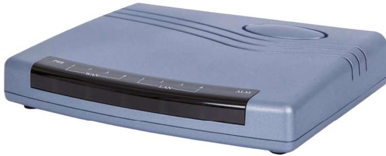
qBRIDGE-106R представляет собой SHDSL.bis модем с поддержкой режима работы «Мост». Предназначен для решения проблем «последней мили», соединения удаленных сегментов LAN, подключения пользователей к Internet. Устройства обеспечивают симметричную полнодуплексную передачу данных по одной медной витой паре в диапазоне скоростей от 200 Kbps до 15,3 Mbps.
