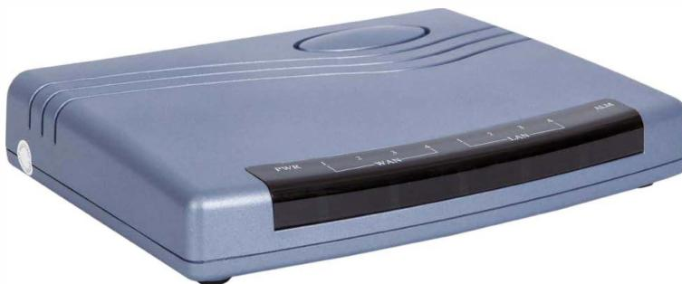
qBRIDGE-206R представляет собой SHDSL.bis модем/ маршрутизатор, разработанный в соответствие с новым стандартом IEEE 802.3ah «Ethernet in the First Mile» (EFM). Линейный интерфейс устройства позволяет объединять до четырех медных пар различного качества для организации симметричного канала 2BASE-TL, используя модуляцию TCPAM-16/32/64/128. При этом обеспечивается линейная скорость до 30.6 Mbps (до 15.3 Mbps по каждой медной паре).
