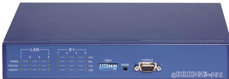
Инверсный мультиплексор qBRIDGE-401 предназначен для соединения удаленных сегментов LAN через транспортные сети PDH/SDH с возможностью объединения 4 каналов E1 для передачи Ethernet трафика. Максимальная скорость составляет 7.68 Mbps при использовании всех четырех каналов E1.
