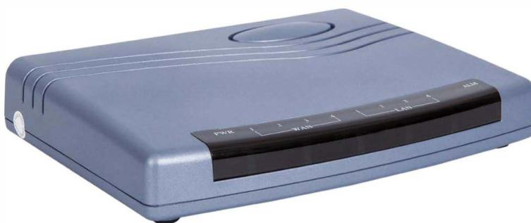
qBRIDGE-406R представляет собой SHDSL.bis модем/ маршрутизатор, разработанный в соответствие с новым стандартом IEEE 802.3ah «Ethernet in the First Mile» (EFM). Линейный интерфейс устройства позволяет объединять до четырех медных пар различного качества для организации симметричного канала 2BASE-TL, используя модуляцию TCPAM-16/32/64/128. При этом обеспечивается линейная скорость до 61.2 Mbps (до 15.3 Mbps по каждой медной паре).
