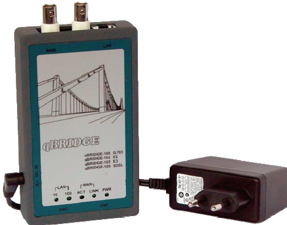
**Индикаторы:** Светодиодные индикаторы отображают состояние устройства qBRIDGE.
