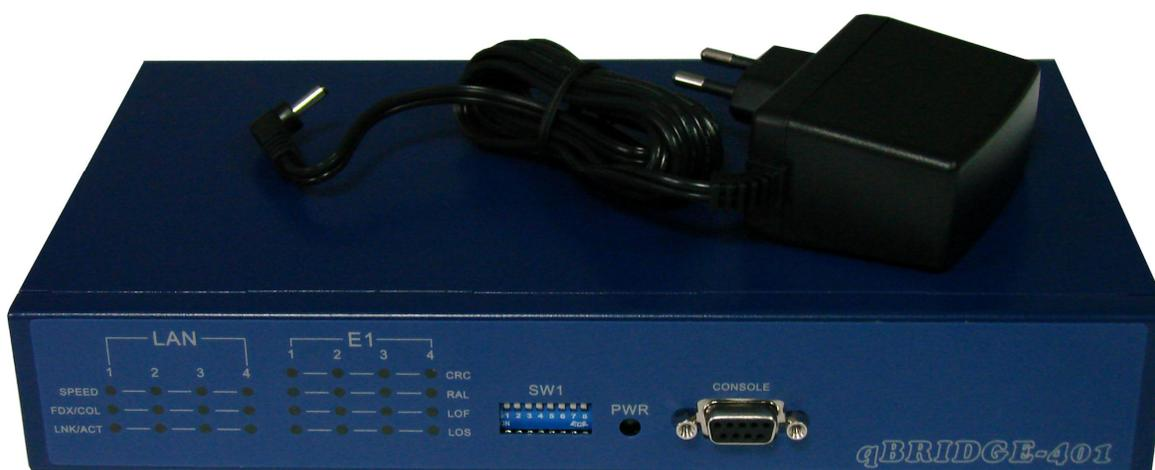
**Передняя панель:** Светодиодные индикаторы отображают состояние устройства qBRIDGE. Переключатель SW1 служит для конфигурирования устройства. В модификации с управляемым коммутатором переключатель не используется. Разъем Console предназначен для подключения терминала для настройки устройства в исполнении с управляемым коммутатором. В модификации с неуправляемым коммутатором разъем Console не используется.
