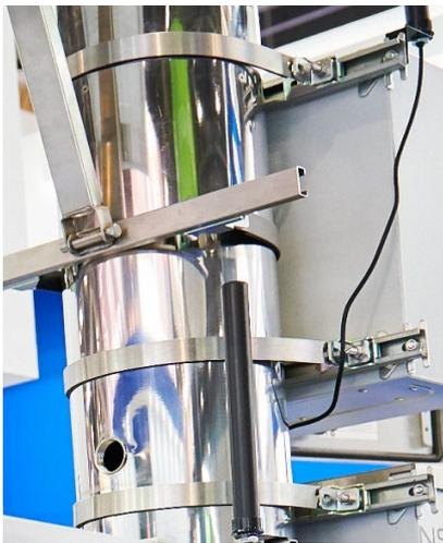
Монтажный комплект NSBon-01 предназначен для быстрого и надежного крепления оснащенных шкафов серии NSB-ххуу | NSE-ххуу на круглых или прямоугольных опорах. Диаметр круглых опор может быть в диапазоне 40-500 мм, а размер прямоугольных опор 60-260 мм. Основные компоненты комплекта выполнены из листовой оцинкованной стали, при этом зажимные ленты изготовлены из нержавеющей стали.
